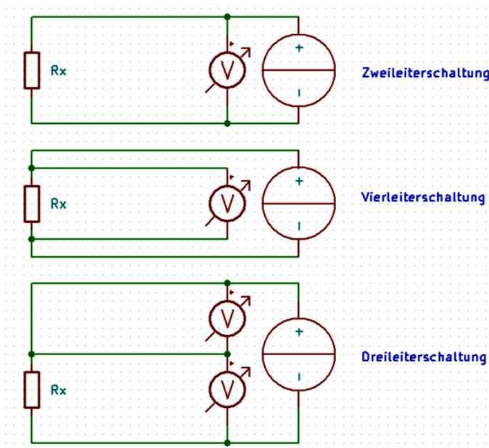
Bitte vergleiche die Schaltungen: Die einfachste Methode ist die Zweileiterschaltung. Stromquelle und Spannungsmessgerät befinden sich am Leitungsende, der zu messende Widerstand wird über ein Leitungspaar angeschlossen. Das System ist einfach und bequem, eventuelle Leitungswiderstände gehen aber voll in das Messergebnis ein.
