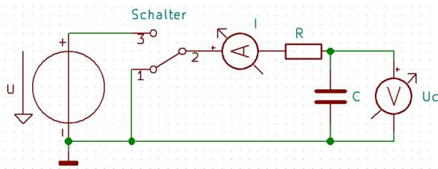
Wir untersuchen als nächstes diese Schaltung. Von links nach rechts sehen wir eine ideale Spannungsquelle, die die feste Spannung  $U$  abgibt. Danach einen Umschalter, der für den Anfang die Kontakte 1 – 2 verbindet und damit dafür sorgt, dass der rechte Teil der Schaltung spannungsfrei ist. Zu Beginn des Versuchs
