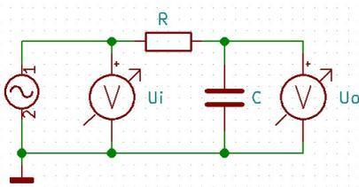
Wir sehen die Wechselspannungsquelle, deren Ausgangsspannung wir mit dem AC – Voltmeter  $U_i$  messen. Darauf folgt der Spannungsteiler R – C. Die Spannung am Kondensator messen wir mit dem AC – Voltmeter  $U_o$ . An sich haben wir gelernt, die Ausgangsspannung eines Spannungsteilers zu berechnen. Diese müsste also so lauten:
