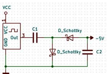
Die tolle Konsequenz dieses Aufbaus ist, dass aus einer positiven Rechteckspannung negative Spannungsimpulse generiert werden. Diese Schaltung wird gerne verwendet, um ohne Spulen (die sind teuer und produzieren elektromagnetische Störfelder) und mit minimalen Kosten aus einer positiven Spannung eine negative mit einer Belastbarkeit von maximal ein paar Milliampere zu gewinnen. Irgendein freies Logikgatter und eine Rechteckspannung findet sich meist von selbst.
