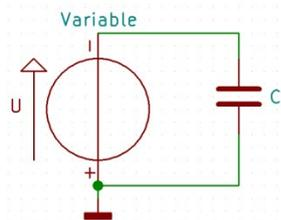
Wir bauen nun diese einfache Schaltung auf: Eine einstellbare Spannungsquelle liegt parallel zu einer Anordnung von zwei voneinander isolierten, aber selbst leitenden Objekten. Wir erinnern uns: Leitfähigkeit bedeutet, dass sich die Ladungsträger frei bewegen können. Wir nehmen einmal an, das seien Metallplatten. Den positiven Anschluss der Anordnung haben wir auf Masse gelegt.
