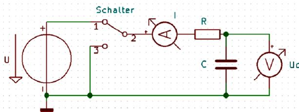
Wir untersuchen diese Schaltung. Von links nach rechts sehen wir eine ideale Spannungsquelle, die die feste Spannung  $U$  abgibt. Danach einen Umschalter, der für den Anfang die Kontakte 1 - 2 verbindet und damit dafür sorgt, dass der Kondensator völlig aufgeladen ist. Zu Beginn
