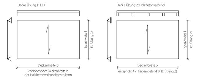
Führen Sie für die in Übung 1 (CLT) und Übung 2 (Holzbetonverbund) bemessenen Deckenkonstruktionen den Schwingungsnachweis nach ÖNORM EN 1995-1-1 bzw. ÖNORM B 1995-1-1.
