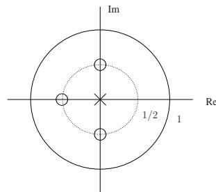
d) Aus dem Schaltbild folgt  $y[n] = x[n] + b_1 x[n-N] + a_1 y[n-1] \rightarrow H(z) = \frac{1+b_1 z^{-N}}{1-a_1 z^{-1}}$ ; Koeffizientenvergleich ergibt  $a_1 = a, b_1 = -a^N$
