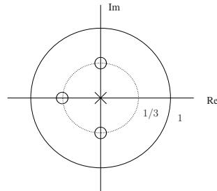
d) Aus dem Schaltbild folgt  $y[n] = x[n] + b_1 x[n-N] + a_1 y[n-1] \rightarrow H(z) = \frac{1+b_1 z^{-N}}{1-a_1 z^{-1}}$ ; Koeffizientenvergleich ergibt  $a_1 = a, b_1 = -a^N$
