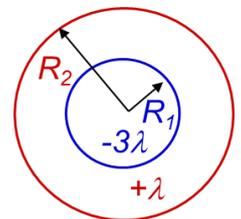
**Kugelkondensator.** Gegeben sind zwei konzentrische, dünnwandige und geladene Metallkugeln der Radien  $R_1$  (Ladung  $-2Q$ ) und  $R_2 > R_1$  (positive Ladung  $+Q$ ).
