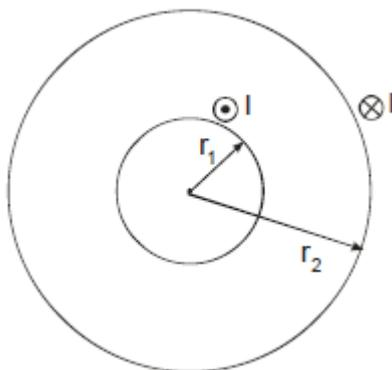
Eine idealisierte Induktivität bestehe aus zwei sehr langen, dünnen konzentrischen Zylinderschalen mit den Radien  $r_1$  und  $r_2$  sowie der Höhe  $h$ . Der innere Zylinder sei vom Strom  $I_1$  durchflossen, der äußere von  $I_2$ . Beide Ströme seien gleich groß,  $I_2$  zeige in die Papierebene,  $I_1$  zeige aus der Papierebene (siehe Skizze). Die Ströme sind gleichmäßig über die Zylinderwände verteilt.
