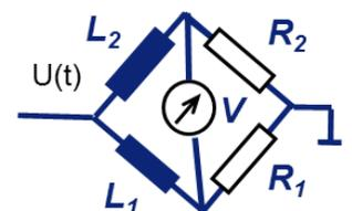
Eine Wheatstonesche Brücke wird aus 4 Elementen und einem idealen Voltmeter aufgebaut wie abgebildet. Die Brücke wird mit einer Wechselspannung  $U(t) = U_0 \exp(i\omega t)$  betrieben.
