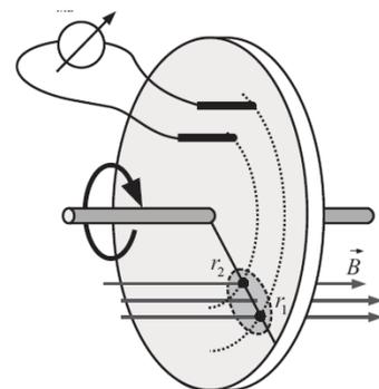
Eine Aluminiumscheibe dreht sich im Magnetfeld ( $B$ ) mit Winkelgeschwindigkeit  $\omega$  (siehe Bild). Zwischen Kontakten im Abstand  $r_1$  und  $r_2$  wird Spannung gemessen. Berechnen Sie diese Spannung.
