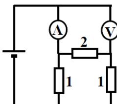
Das Voltmeter im angegebenen Schaltkreis zeigt den Wert  $U = 6V$ . Welcher Strom wird vom Amperemeter angezeigt? Widerstände sind in Ohm angegeben. Die Messgeräte können als ideal angenommen werden.
