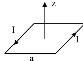
Ausgehend vom Biot-Savartschen Gesetz finden Sie das magnetische Feld einer quadratischen Stromschleife mit Strom  $I$  und Kantenlänge  $a$  entlang der  $z$ -Achse (Symmetrieachse) für  $z \gg a$ . Nennen Sie 2 physikalische Merkmale dieser Formel.
