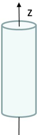
Ein unendlicher zylindrischer Leiter der Radius  $R$  trägt den Strom der Dichte  $j$  [ $\text{A}/\text{m}^3$ ] entlang der  $z$ -Richtung (homogen verteilt, Bild). Der Zylinder ist außerdem magnetisch mit der Suszeptibilität  $\chi$ . Berechnen Sie die magnetischen Felder  $B$ ,  $H$  im gesamten Raum.
