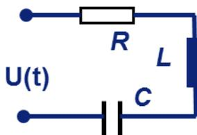
Ein Serienschwingkreis wird mit Spannung  $U(t) = U_1 e^{i\omega t} + U_2 e^{2i\omega t}$  betrieben. Berechnen Sie den Strom durch den Widerstand. (Einschwingvorgang vernachlässigen)
