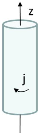
Ein langer magnetischer Zylinder (Symmetrieachse  $z$ , Permeabilität  $\mu$ ) trägt im Volumen einen Kreisstrom mit der variablen Stromdichte  $\mathbf{j}(\mathbf{r}) = \alpha \cdot \mathbf{r}$  [ $A/m^2$ ], siehe Bild. Hier  $r$  ist der Abstand von der  $z$ -Achse. Berechnen Sie das Magnetfeld im gesamten Raum.
