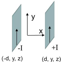
Zwei planparallele Ebenen befinden sich im Abstand  $2d$  voneinander und tragen Stromdichten  $+I$  [A/m] und  $-I$  [A/m] parallel zu der  $y$ -Achse (siehe Bild).
