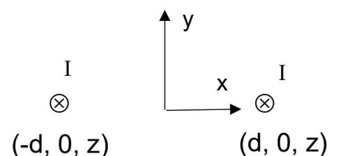
Zwei zueinander parallele unendlich lange Stromleitungen tragen gleichen Strom  $I$  und befinden sich im Abstand  $d$  voneinander. Berechnen Sie explizit die die Kraft zwischen beiden Leitungen.
