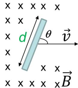
Ein metallischer Stab bewegt sich im Magnetfeld (siehe Bild). Berechnen Sie die Spannungsdifferenz an den Enden des Stabes.
