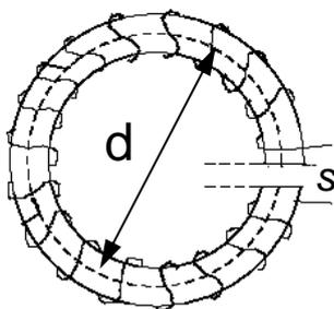
Ein torusförmiger Eisenkern (magnetische Permeabilität  $\mu$ ) mit dem mittleren Durchmesser  $d$  und dem Luftspalt  $s$  ist gleichmäßig mit  $N$  Windungen bewickelt. Wie groß ist das Magnetische Feld im Spalt wenn durch die Windungen ein Strom  $I$  fließt? (Detaillierte Berechnung)
