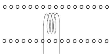
Innerhalb einer langen großen Spule der Länge  $\ell$  und Radius  $R_1$  mit  $N_1$  Windungen befindet sich eine kurze kleine Messspule mit dem Radius  $R_2 < R_1$  mit  $N_2$  Windungen. Die Achsen der Spulen sind parallel angeordnet. Die Große Spule wird mit einer Spannung  $U_0 \exp(i\omega t)$  betrieben. Finden Sie die Spannung an der Messspule. (Randeffekte vernachlässigen)
