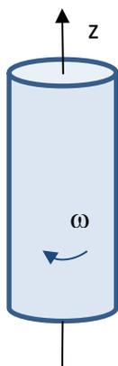
Ein langer homogen geladener Zylinder ( $R$  - Radius,  $\rho$  - Ladungsdichte) dreht sich um seine Achse mit konstanter Winkelgeschwindigkeit  $\omega$  (siehe Skizze). Berechnen Sie das magnetische Feld entlang der  $z$ -Achse.
